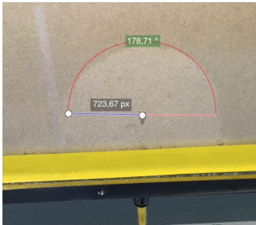
Fig. 18 : Cellule 2D contenant du sable humide, séché par injection d'air sec grâce à une aiguille placée à sa base. Le sable sec apparaît comme étant plus clair que le sable humide. La forme de cette zone séchée est à peu près circulaire, centrée autour du point d'injection. On peut donc estimer son rayon au cours du temps. (photo N. Chapuis)
