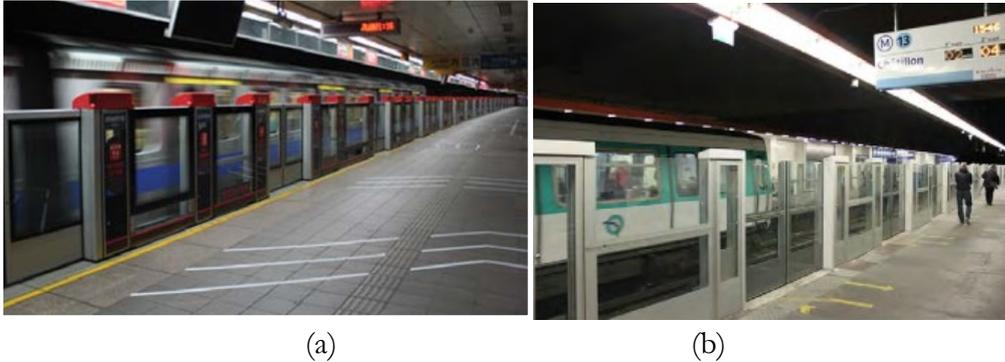
Figure 35. Portes palières automatiques (a)<sup>11</sup> Métro de Taipei (b)<sup>12</sup> Métro de Paris ligne 13
