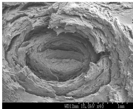
FIG. II - 4.2 – Zone contenant le défaut menant à l'amorçage de fissure sous les inserts (éprouvette TTF200-2c).
