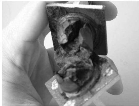
FIG. II - 3.9 – Rupture d'une éprouvette Diabolo en compression répétée.
