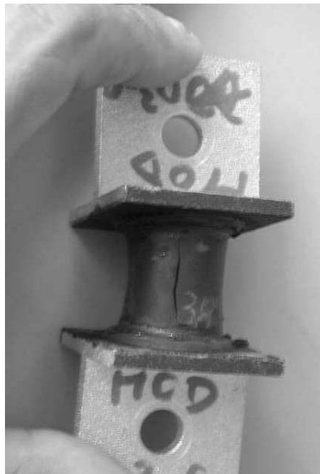
FIG. II - 3.10 – Fissure selon l'axe de l'éprouvette Diabolo en compression répétée.
