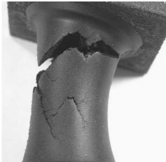
FIG. II - 3.8 – Branching à mi-hauteur de l'éprouvette Diabolo (Traction/traction 67-200%, R_\epsilon = 0,33 , éprouvette TTD20-6b).
