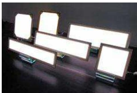
**Figure 2** Panneaux lumineux à base d'OLED de l'entreprise Lumiotec (Japon)<sup>17</sup>
