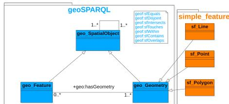
FIGURE 3 – Diagramme de classes autour du module ontologique cœur de GeoSPARQL.
