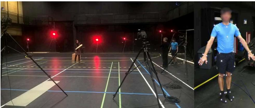
À gauche : session de capture de mouvement sur le plateau Immermove dans les locaux du laboratoire M2S. À droite : positionnement des marqueurs.
