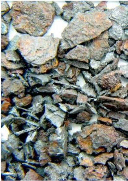
Figure 31 : Quelques battitures après lavage et tri
