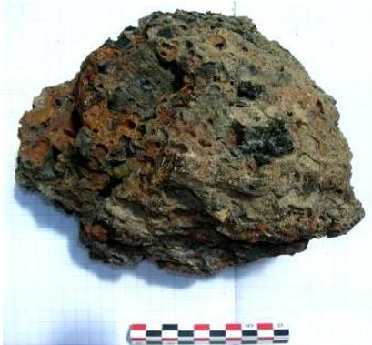
Figure 26 : Laitier de haut fourneau avec gros charbon de bois produits aux environs du XVI<sup>e</sup>-XVII<sup>e</sup> siècle
