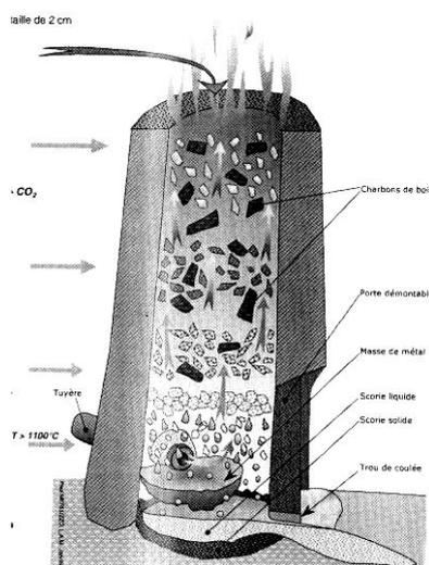
Figure 8 : Schéma d'un four à scorie écoulée (DAO Paul Merluzzo)
