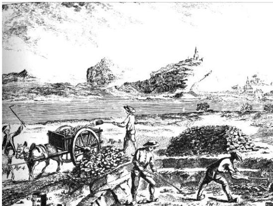
Fig. 1 : Ramassage des minerais en rognons dans les couches superficielles du sol (Diderot et d'Alembert 1751-1772)
