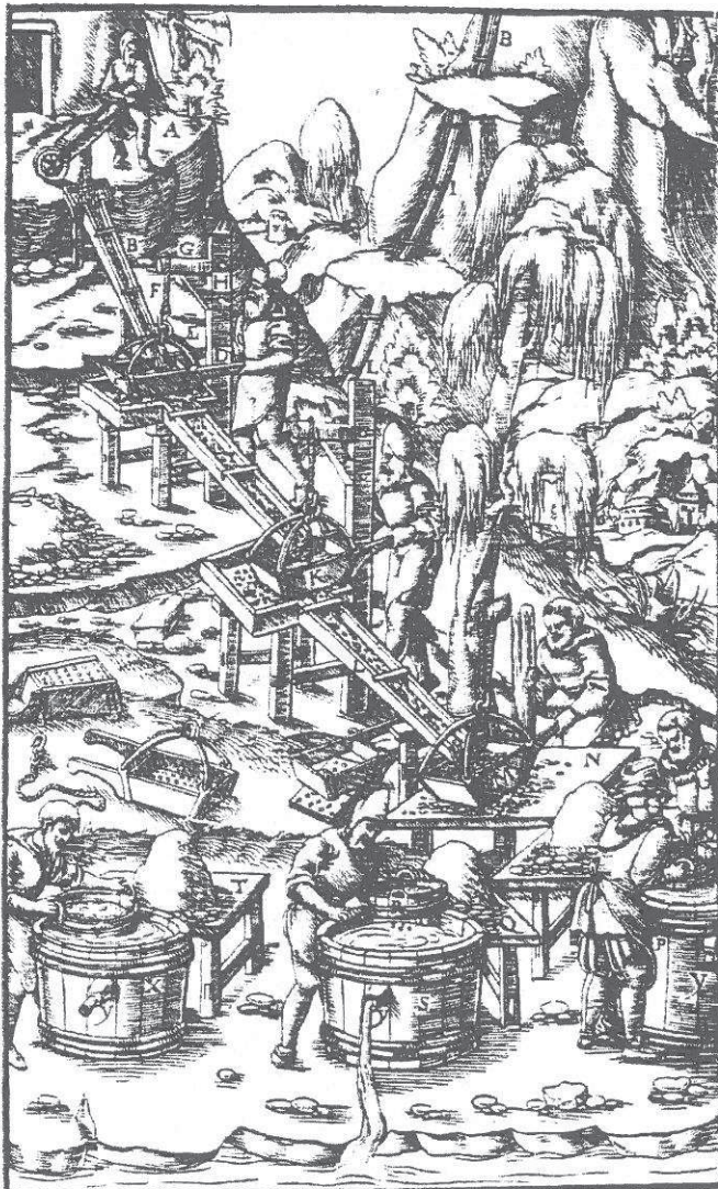
A : Ouvrier transportant les graviers avec une brouette B : Première longue goulotte C : Première petite caisse D : Ses poignées E : Ses anses F : La corde G : La potence H : Son montant I : La seconde goulotte K : La seconde petite caisse L : La troisième goulotte M : La troisième petite caisse N : Première table O : Premier tamis P : Premier baquet Q : Seconde table R : Second tamis S : Second baquet T : Troisième tamis V : Troisième tamis X : Troisième baquet Y : Bandes
