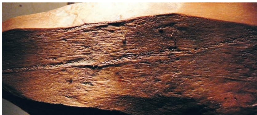
Fig. 350 : Rayure longitudinale d'un pieu de chêne de la plage Saint-Michel consécutive à son enfoncement (photo : V. BERNARD).
