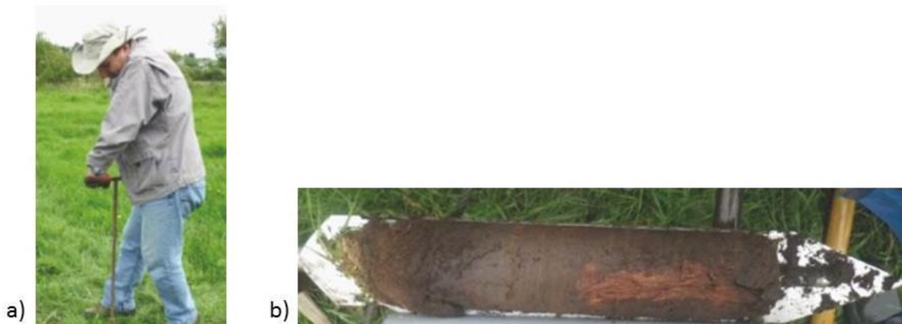
Figure 2. Carottages palynologiques manuels avec la sonde GYK. a) extraction de la carotte sur le terrain ; b) carotte de sédiment dans le carottier GYK (photos : C. Leroyer).
