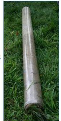
Cylindre de sol non remanié dans une chemise transparente
