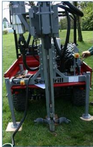
Tige d'acier entre le marteau et le carottier pour un échantillonnage plus profond
