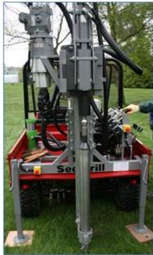
Percussions du marteau hydraulique sur le carottier
