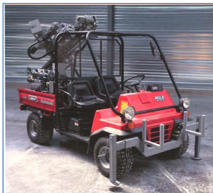
Figure 4. Foreuse-carotteuse Sedidril 80 installée sur le porteur Mule (photo : entreprise Sedidril).
