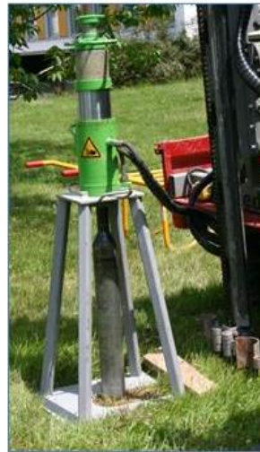
Extracteur hydraulique à bille pour retirer le carottier en cas de blocage
