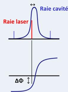
$\Delta\Phi$  est l'écart de phase entre l'onde incidente et l'onde réfléchie
