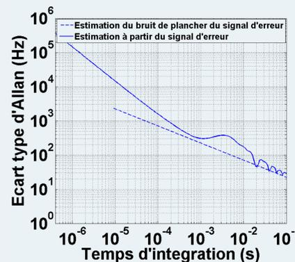
Ecart type d'Allan du signal d'erreur calibré  $\varepsilon(f)$  en Hz/ $\sqrt{\text{Hz}}$
