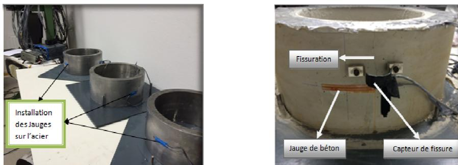
**Figure 2.** Schéma du dispositif de retrait empêché
