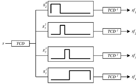
Fig 3 : Synthèse des signaux de sous bandes correspondant au banc de filtre associé à la meilleure base décrite figure 1b).
