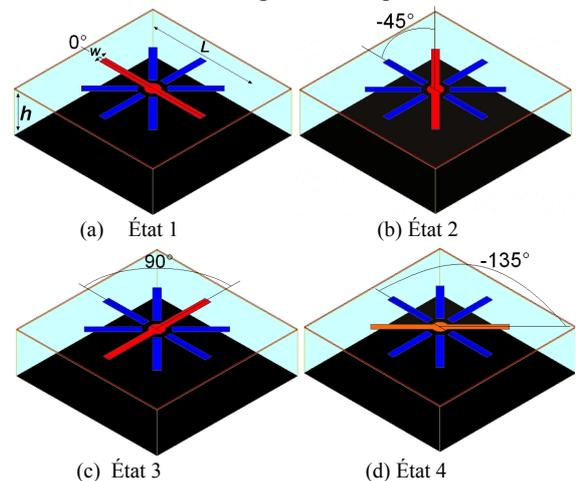
Figure 4. États optimisés de la seconde couche de la cellule unitaire.  $L=16,6\text{mm}$ ,  $w=1\text{mm}$ ,  $h=6,5\text{mm}$ .
